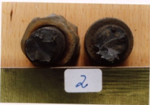
Mýnd 3. Mýndin sýnir brotsár í bolta nr. 2. Dreifisprangur hufu myndast við gengisbata þar sem pyntastæring er antalsverð.
