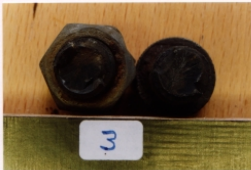
Mýnd 4. Mýndin sýnir brotsár í bolta nr. 3. Merki eru um málnþreytu við gengjubotn en rennbrot er svo til allur brogflötur.
