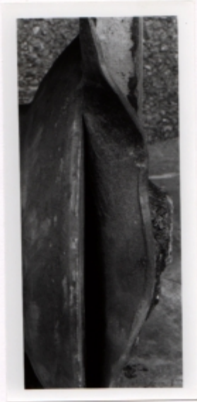
Mynd 8 Nærmynd af boginni hlíf.
