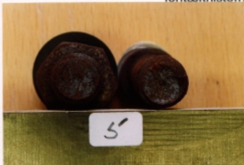
Mýnd 6. Mýndin sýnir brotsár í bolta nr. 5. Veldjárskodur gaf til kynna að um stókk brot er að ræða.
