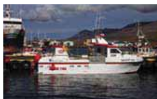
Skipaskr.nr. 2630 Smiðaður: Reykjavík 2004, Plast Stærð: 11,0 brl. 12,5 bt. Mesta lengd: 11,1 m Skráð lengd: 11,09 m Breidd: 3,27 m Dýpt: 1,3 m Vél: Cummins 302 kW, 2004 Fjöldi skipverja: 2
