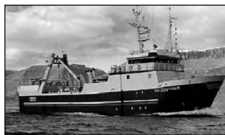
Frosti PH 229S. Skipaskr.nr. 2067. Smíðaður: Gdansk Pólland 1990. Stærð: brl. 392.9 bt. 622.0. Mesta lengd: 39.3 m. Skráð lengd: 34.65 m. Breidd: 9.4 m. Dýpt: 6.5 m. Vél: Sulzer Cegielski, 1280 kW, 1989/7 Fjöldi skipverja: 17.
