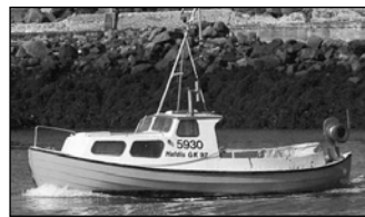
Hafdis GK 92. Skipaskr.nr. 5930. Smíðaður: Hafnarfjörður 1978, plast. Stærð: 2,17 brl. 3,71 bt. Mesta lengd: 7,43 m. Skráð lengd: 7,33 m. Breidd: 2,23 m. Dýpt: 0,70 m. Vél: Volvo Penta 1977, 26 kW Fjöldi skipverja: 2.
