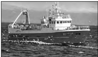
Smáey VE 144. Skipaskr.nr. 2433. Smíðaður: Kína 2001, stál Stærð: 209 brl. 327 bt. Mesta lengd: 28,87 m. Skráð lengd: 26,04 m. Breidd: 9,17 m. Dýpt: 6,05 m. Vél: Yanmar 700 kW, 2001. Fjöldi skipverja: 13.
