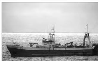
Breki KE 611. Skipaskr.nr. 1459. Smíðaður: Akureyri 1976, stál. Stærð: 599 brl. 924 bt. Mesta lengd: 59,15 m. Skráð lengd: 53,47 m. Breidd: 9,5 m. Dýpt: 6,95 m. Vél: MAN B&W 1766 kW, 1987 Fjöldi skipverja: 13.
