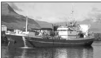
Oddeyrin EA 210. Skipaskr.nr. 1046. Smíðaður: Noregi 1967, stál. Stærð: 335 brl. 498 bt. Mesta lengd: 49,96 m. Skráð lengd: 45,86 m. Breidd: 7,62 m Dýpt: 6,15 m. Vél: Alpha Diesel 1080 kW, 1989 Fjöldi skipverja: 4.
