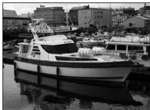
Elding II - farþegaskip Skipaskr.nr. 7489. Smíðaður: HALMATIC 1987, trefjaplast. Stærð: 25,85 brl. 29,65 bt. Mesta lengd: 15,34 m. Skráð lengd: 14,71 m Vél: CATERPILLAR 350,74 kW Fjöldi skipverja: 3 Fjöldi farþega: 22
