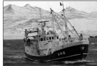
Egill Halldórsson SH-2 Skipaskr.nr. 1458. Smíðaður: Stál, Seyðisfirði, 1976. Stærð: 101 brl. 114 bt. Mesta lengd: 26,92 m. Skráð lengd: 23,90 m. Breidd: 5,90 m. Dýpt: 3,10 m. Vél: Caterpillar 313 kW. Fjöldi skipverja: 6
