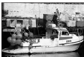
Þerna SH 350. Skipaskr.nr. 2314. Smiðaður: Hafnarfirði 1998, plast. Stærð: 6,80 brl. 5,75 bt. Mesta lengd: 9,05 m. Skráð lengd: 7,97 m. Breidd: 2,92 m. Dýpt: 1,18 m. Vél: Cummins 184 kW Fjöldi skipverja: 2
