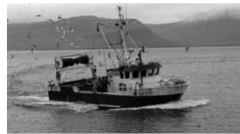
Brekey BA 236. Skipaskr.nr. 1890. Smiðaður: Stál, Ísafirði, 1988/4. Stærð: brl. 11. bt. 22. Mesta lengd: 14,00 m. Skráð lengd: 13,00 m. Breidd: 3,00 m. Dýpt: 1,00 m. Vél: Caterpillar 147 kW
