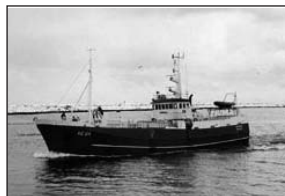
Sædis HF 60. Skipaskr.nr. 89. Smíðaður: Flekkefjord, Noregi, 1963/10, Stál. Staerð: 179 brl. 275 bt. Mesta lengd: 36,50 m. Skráð lengd: 32,83 m. Breidd: 6,72 m. Dýpt: 5,72 m. Vél: Caterpillar 671 kW. Fjöldi skipverja: 12
