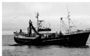
Júpíter PH-61. Skipaskr.nr. 130. Smíðaður: Stál, Bremerhaven, Þýskalandi, 1957 Stærð: 747 brl. 1033 bt. Mesta lengd: 64,50 m. Skráð lengd: 56,83 m. Breidd: 9,75 m. Dýpt: 7,68 m. Vél: Wärtsilä 1943 kW. Fjöldi skipverja: 15
