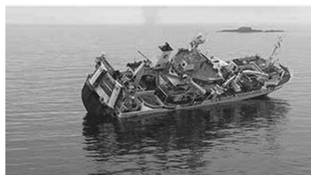
Guðrún Gísladóttir KE 15. Skipaskr.nr. 2413. Smíðaður: Huangpu, Kína 2001 Stærð: 1301 brl. 2626 bt. Mesta lengd: 71,48 m Skráð lengd: 64,30 m Breidd: 14 m Dýpt: 9,65 Vél: Bergen Diesel 5299 kW. Fjöldi skipverja: 20
