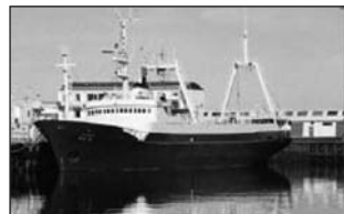
Bravó SH 543. Skipaskr.nr. 1268. Smíðaður: Gdynia, Póllandí, 1972/11, Stál. Stærð: 857 brl. 1126 bt. Mesta lengd: 67,92 m. Skráð lengd: 61,35 m. Breidd: 11,30 m. Dýpt: 7,30 m. Vél: Mirreles Blackst 1596 kW. Fjöldi skipverja: 7
