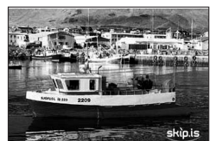
Sjófugl ÍS 220 Skipaskr.nr.: 2209 Smíðaður: Gdansk Póllandí 1990 Plast Stærð: 5,00 brl; 7,00 bt Lengd: 9,97 m Breidd: 2,87 m Dýpt: 1,11 m Vél: Deutz Vetus 121,00 kW
