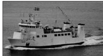
Baldur 2044. Skipaskr.nr. 2044. Smíðaður: P. & E. Akranesi 1990/4, stál. Stærð: 301 brl. 645 bt. Mesta lengd: 39,00 m. Skráð lengd: 37,50 m. Breidd: 9,02 m. Dýpt: 6,06 m. Vél: Caterpillar 1990/04, 1413 hð, 1038 kW. Fjöldi skipverja: 6
