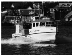
Narfi SU 680. Skipaskr.nr. 2485. Smiðaður: Hafnarfirði 2001, plast. Stærð: 7,09 brl. 5,92 bt. Mesta lengd: 9,49 m. Skráð lengd: 8,02 m. Breidd: 2,97 m. Dýpt: 1,22 m. Vél: Yanmar 276 kW. Fjöldi skipverja: 2
