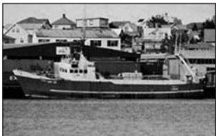
Sturla GK-12. Skipaskr.nr. 1612. Smíðaður: Stál, Wallsend, Bretlandi 1974. Stærð: 297 brl. 276 bt. Mesta lengd: 35,87 m. Skráð lengd: 31,92 m. Breidd: 8,32 m. Dýpt: 4,90 m. Vél: Bergen Diesel 729 kW (990 hð). Fjöldi skipverja: 10
