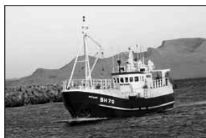
Rifsari SH 70 Skipaskr.nr. 1856 Smiðaður: Gdansk, Pólland 1987, stál. Stærð: 81 brl., 98 bt. Mesta lengd: 25 m. Skráð lengd: 22 m. Breidd: 6,00 m, Dýpt: 3,00 m. Vél: Caterpillar 459 kW Fjöldi skipverja: 5
