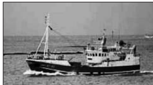
Sandafell ÍS 82. Skipaskr.nr. 1812. Smíðaður: Gdansk, Pólland, 1988/8. Stærð: 89,5 brl. 111 bt. Mesta lengd: 25,93 m. Skráð lengd: 23,47 m. Breidd: 6,00 m. Dýpt: 3,00 m. Vél: Caterpillar 456 kW, 1988.
