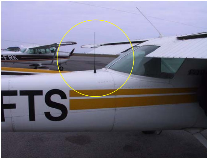
mynd 13, samskonar loftnet fyrir neyðarsendi á flugvél af sömu tegund og TF-FTR
