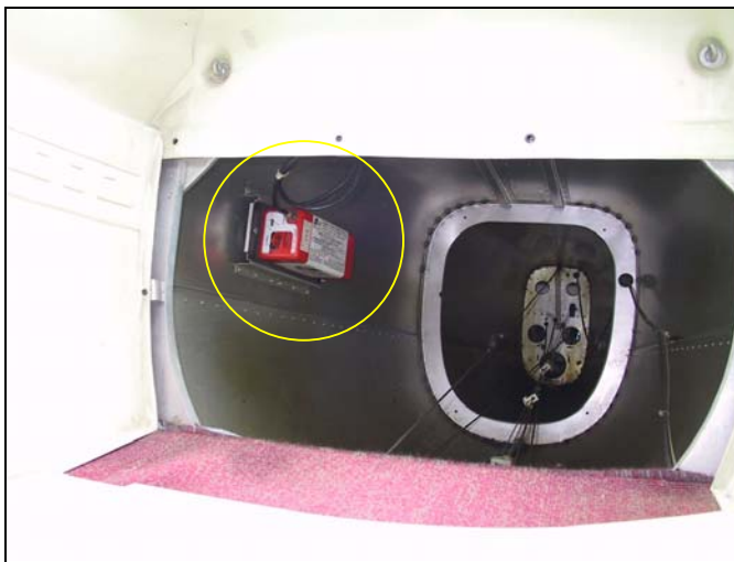
mynd 14, samskonar neyðarsendir og var í TF-FTR
