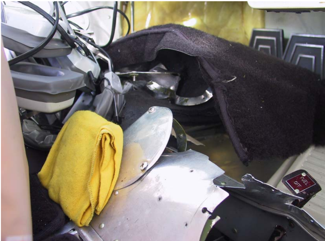
Mynd 2, gólf í flugstjórnarklefa flugvélarinnar rifnaði og eldsneytiskraninn brotnaði
