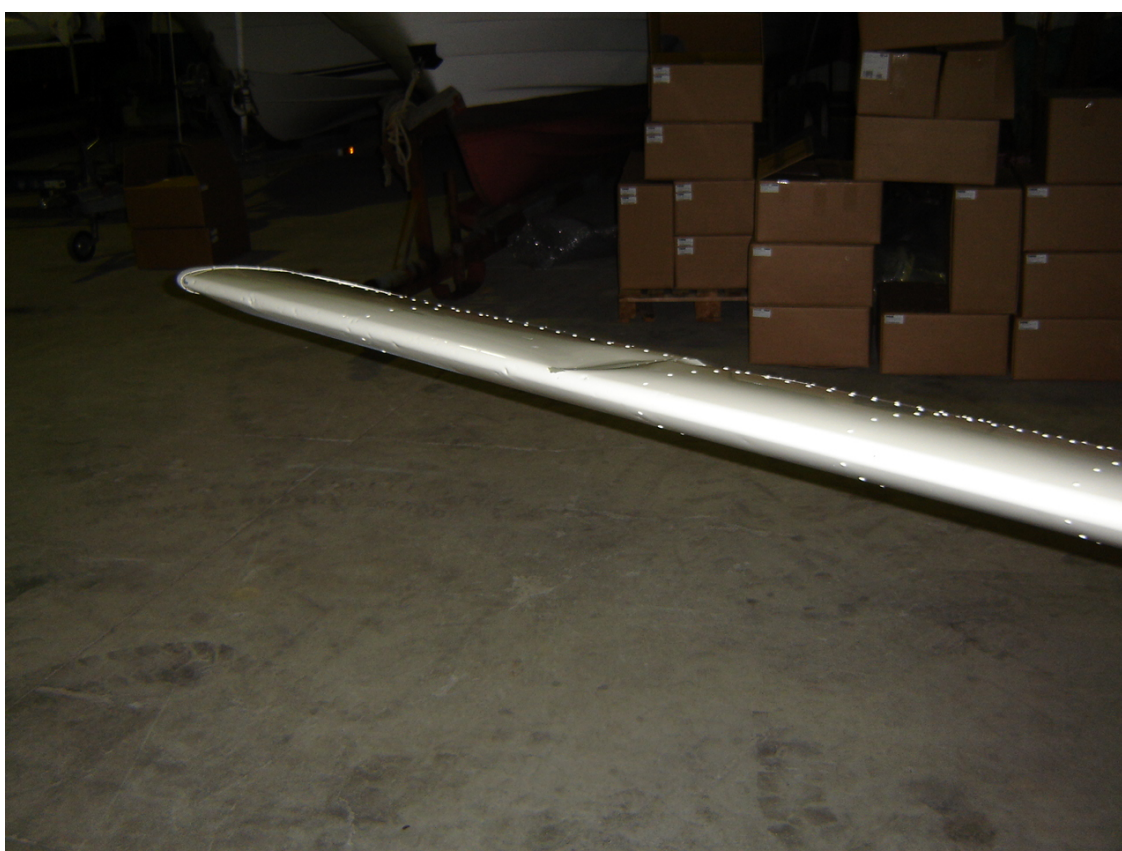
Mynd 3: Brot í skinni efri hluta hæðarstýris.
