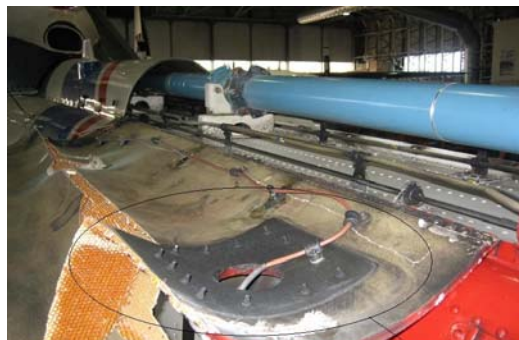
Mynd 3: Hlíf fyrir drifsköft og festing fyrir GPS loftnet
