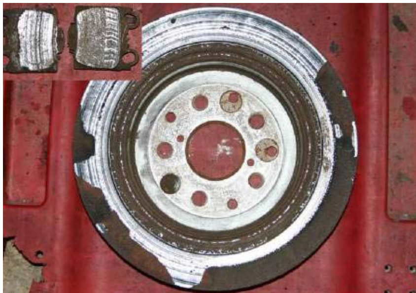
Mynd af mikið ryðguðum hemladisk. Mynd fengin frá Fræðslumiðstöð bílgreina.
