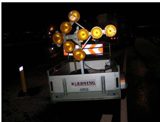
Blikkljós á stefnuör blikkuðu ekki. Geymirinn var rafmagnslaus
