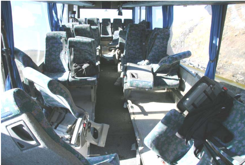
Mynd 3. Horft aftur í hópbifreiðina. Sætisbækkir losnuðu þar sem festingar voru ekki tryggar.
