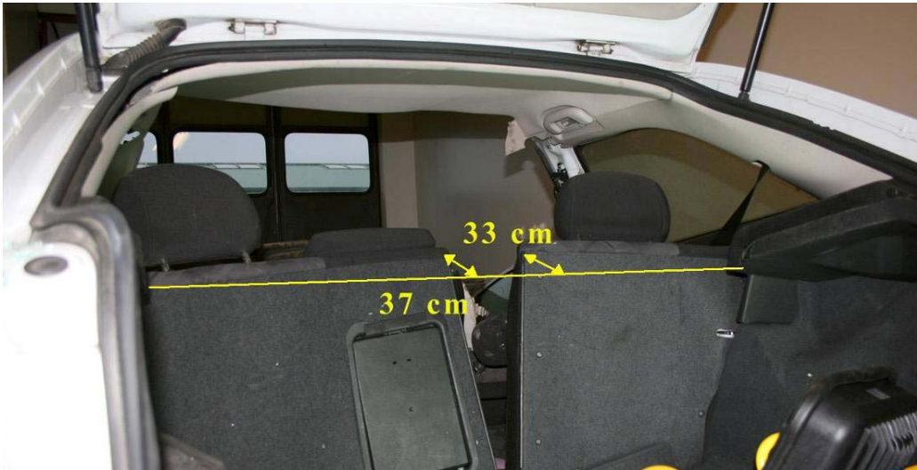
Mynd tekin inn í farangursrými Opel bifreiðarinnar. Aftursætisbökinn bognuðu mikið fram vegna þungs farangurs sem var í farmrými bifreiðarinnar.
