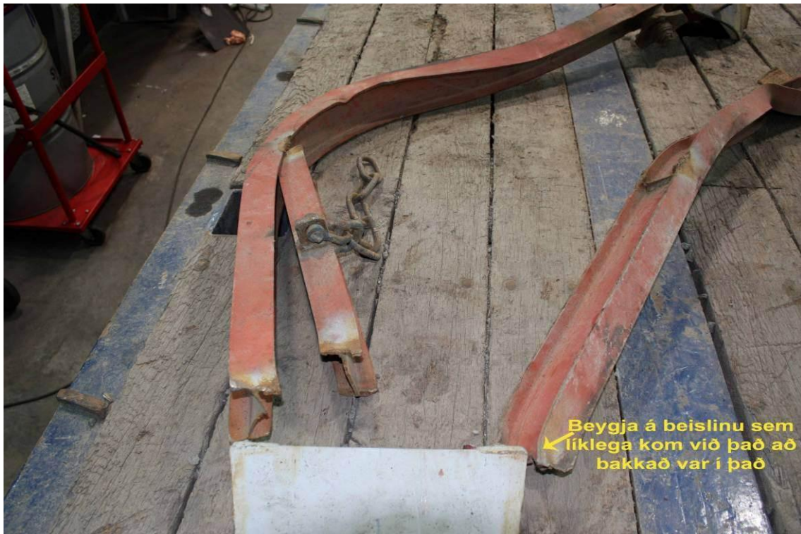
Mynd 8. Beislið eftir slysið. Líklegt er að beygjan sem gula örin bendir á hafi verið til staðar fyrir slysið (sjá mynd 6).
