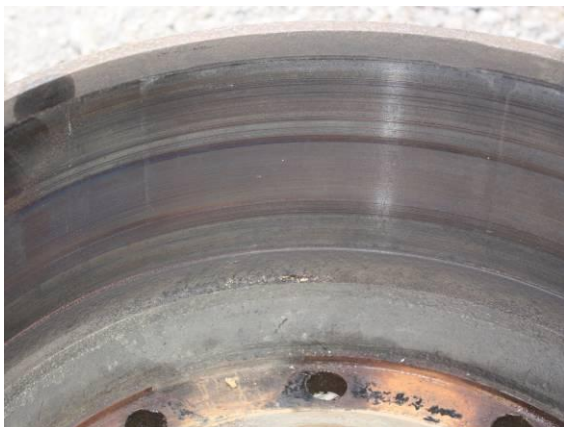
Mynd 4: Hemlaskálin hægra megin að framan. Greinilegur blámi var á slitfleti hennar.
