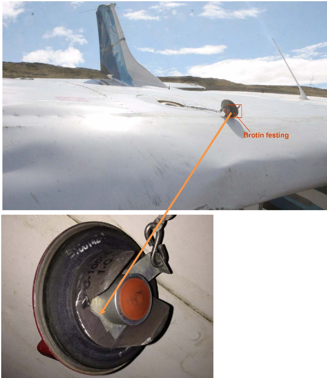
Mynd 8: Brotin festing á eldsneytisloki ofan á hægri væng
