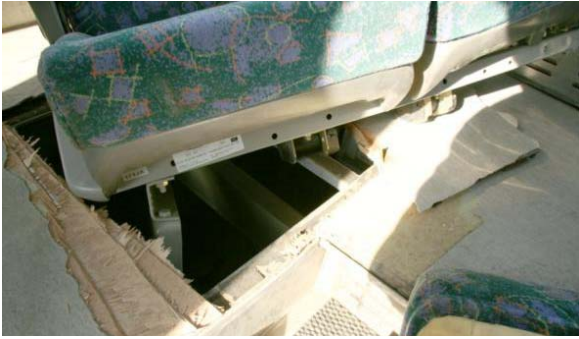
Mynd 12: Þessi sæti voru fest í botnplötuna sem höldi ekki álagið og brotnaði.
