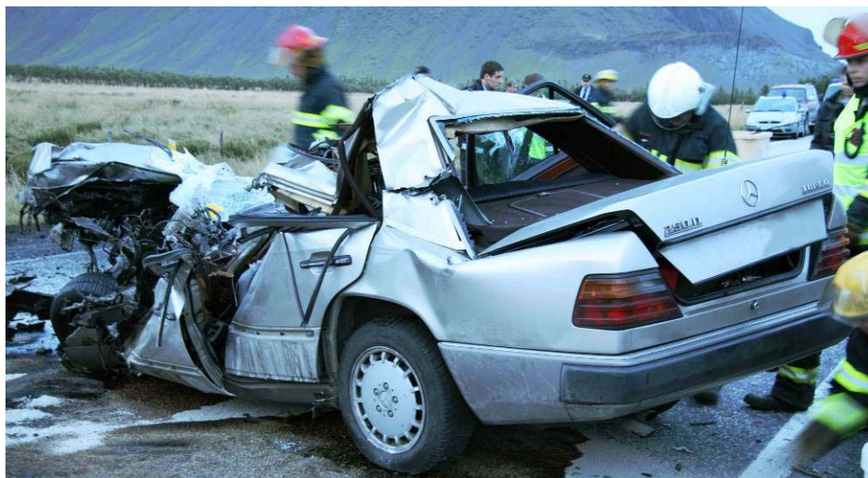
Mynd 1: Fólksbifreið eftir framanákeyrslu við vörubifreið. Mikil aflögun var inn í farþegarými fólksbifreiðarinnar en engin aflögun var inn í ökumannsrými vörubifreiðarinnar.
