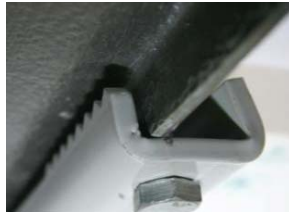
Mynd 13: Frágangur sætafesta við ytra byrði. Tenntur flötur klemmunar náði ekki spyrnu við hliðarsleða.
