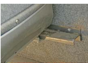
Mynd 13: Frágangur sætafesta við ytra byrði. Tenntur flötur klemmunar náði ekki spyrnu við hliðarsleða.
