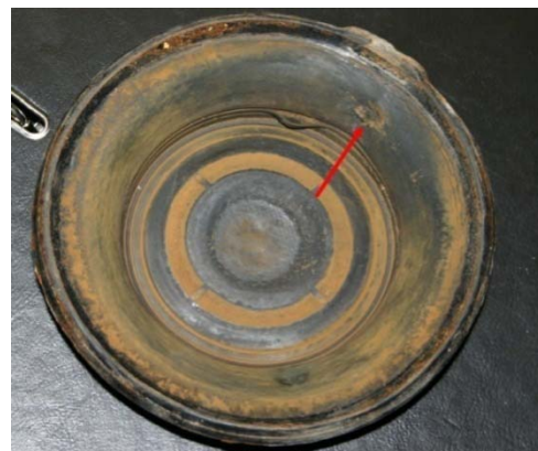
Mynd 11: Rauð ör bendir á gat í membrunni. Mynd fengin úr skýrslu um bíltækniskoðun um slysið.
