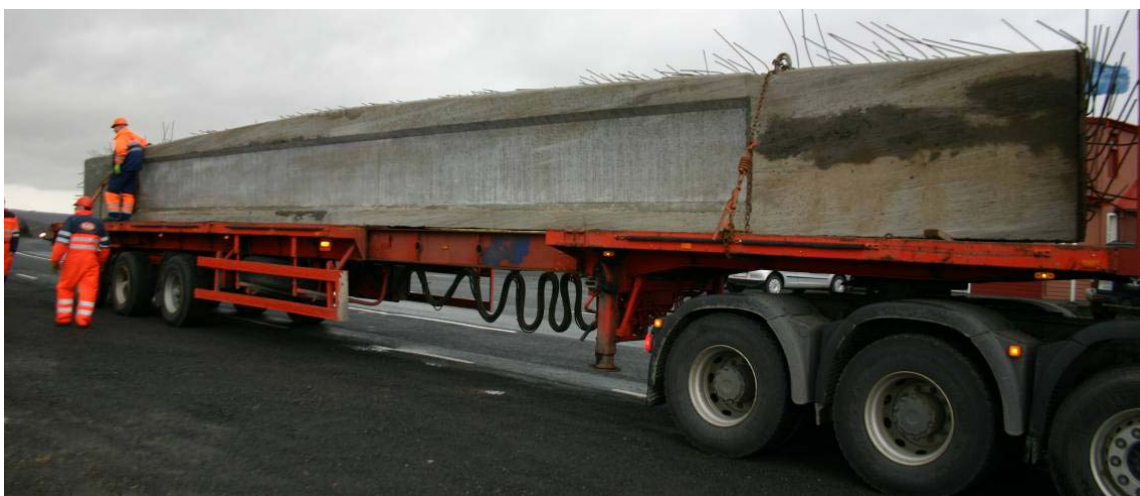
Mynd 7: Aftanívagn með tvo rúmlega 13 tonna bita.
