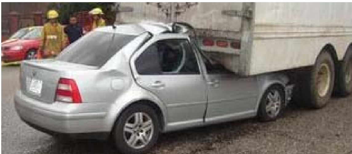
Mynd 2: Mjög mikil aflögun inn í farþegarými fólksbifreiðarinnar, en styrktarbitar og hvalbakur eru lítið skemmdir. Góð og sterk undirakstursvörn hefði mögulega getað bjargað miklu í þessu slysi.
